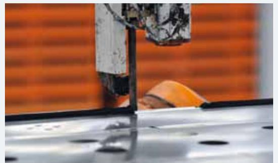
Terostat MS 接着剤が自動的に鉄骨フレームに押し出され、フレームと反射ミラーを接着します。
