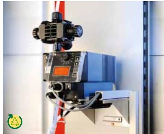
ヘンケルの Lineguard Supervisor は、金属前処理の継続モニタリング向け制御・モニタリングシステムで、必要な化学品量を正確に特定することができます。システム上で過剰投入を防ぐだけでなく、コーティングの仕上がりも均一になります。
